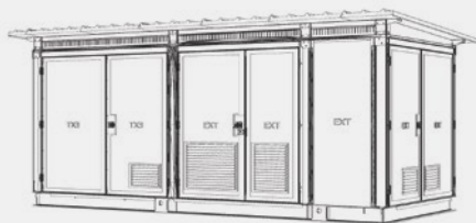
Espe Power Shelter con trasformatore in resina
